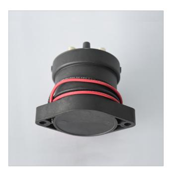
测量吸合电压和吸合电流,找来可调稳压电源和电流表,给高压直流继电器输入一组电压,且在供电回路中串入电流表进行监测。慢慢调高电源电压,听到继电器吸合声时,记下该吸合电压和吸合电流。为求准确,可以试多几次而求平均值。当继电器发生吸合后,再逐渐降低供电电压,当听到继电器再次发生释放声音时,记下此时的电压和电流,亦可尝试多几次而取得平均的释放电压和释放电流。一般情况下,继电器的释放电压约在吸合电压的10~50%,如果释放电压太小(小于1/10的吸合电压),则不能正常使用了,这样会对电路的稳定性造成威胁,工作不可靠。南京高电压配套设备继电器企业高压直流继电器是工业生产和我们生活中常用的一种电气控制设备。
