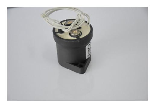
高压直流继电器输入量达到规定值时,使被控制的输出电路导通或断开的电器。可分为电气量继电器及非电气量继电器两大类。具有动作快、工作稳定、使用寿命长、体积小等优点。普遍应用于电力保护、自动化、运动、遥控、测量和通信等装置中。主继电器一般由铁芯、线圈、衔铁、触点簧片等组成的。只要在线圈两端加上一定的电压,线圈中就会流过一定的电流,从而产生电磁效应,衔铁就会在电磁力吸引的作用下克服返回弹簧的拉力吸向铁芯,从而带动衔铁的动触点与静触点吸合。当线圈断电后,电磁的吸力也随之消失,衔铁就会在弹簧的反作用力返回原来的位置,使动触点与原来的静触点释放。这样吸合、释放,从而达到了在电路中的导通、切断的目的。
